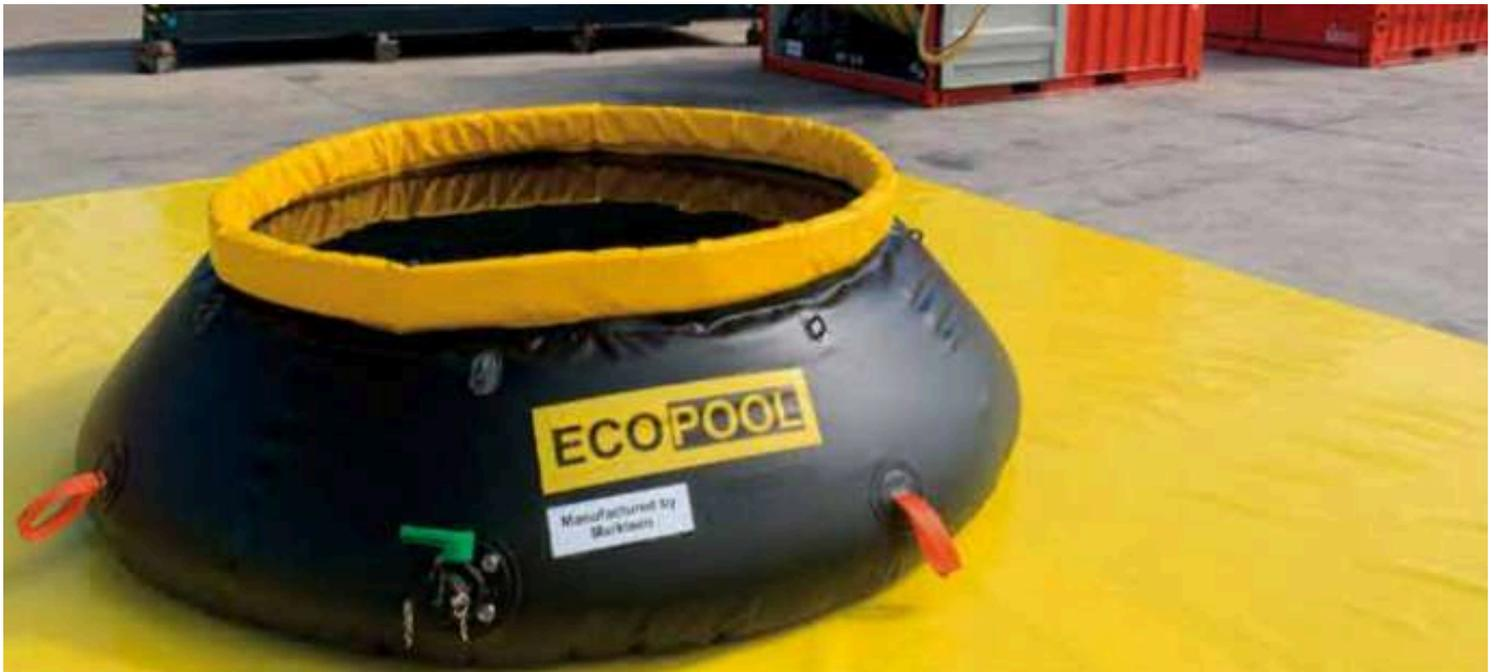
Listo para usar de inmediato. No requiere ninguna estructura, debido al collar rígido que mantiene su forma. Todos los tanques se pliegan fácilmente para el transporte. Sistemam de carga con válvula de bola camlock macho de 2" y 4 asas de manejo
